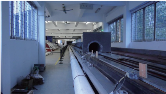
(b) 列车 39 m 2 单线隧道模型 图7 动模型试验平台
